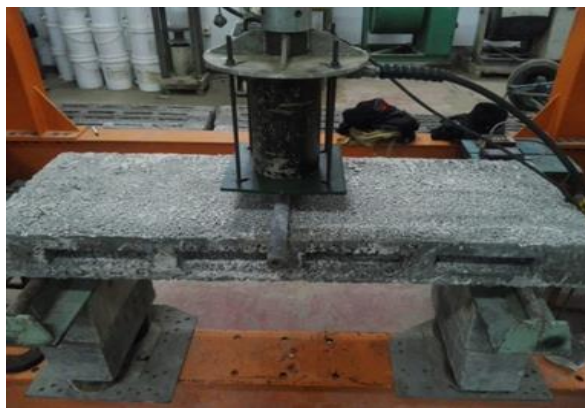
Gambar 3. Pengujian kuat lentur dinding panel beton Styrofoam
