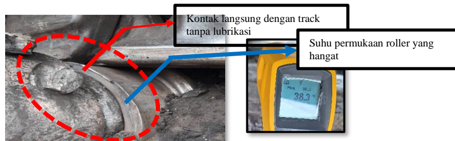
Gambar 5. Abnormal worn out pada carrier roller
