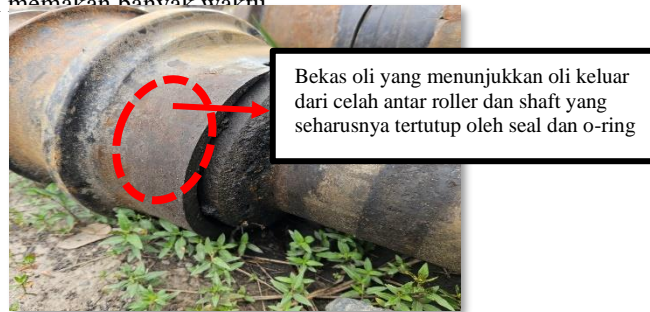
Gambar 7. Kebocoran pelumas pada carrier roller
