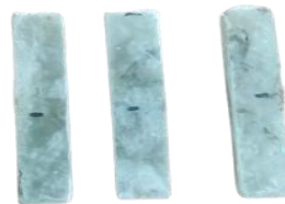
Gambar 2. Spesimen Uji Impak yang Sudah Dipotong
