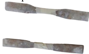
Gambar 1. Spesimen Uji Tarik yang Sudah Dipotong
