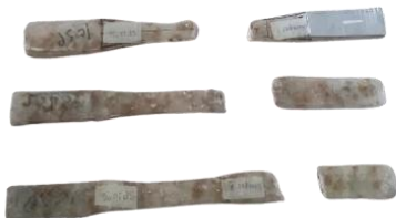
Gambar 3. Spesimen Setelah Uji Tarik
