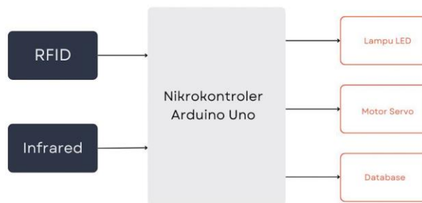
Gambar 2. Diagram Blok Sistem Palang Pintu Otomatis (1)
