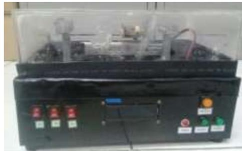
**Gambar 2** Gambar Set Alat Konveksi pada Zat Gas.
