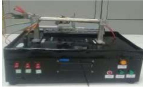
**Gambar 1** Pada percobaan konduksi menggunakan bahan aluminium, tembaga, dan besi. Dan pada pengambilan data sudah secara otomatis dilihat pada LCD, dan sudah berbasis digital.
