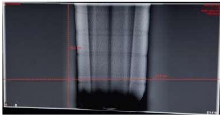
Gambar 2. Hasil dimensi berkas sinar-X pada reseptor citra mode panoramic pada pesawat sinar-X radiografi gigi panoramic cephalometri
