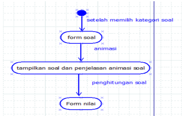
Gambar 5. Activity Diagram Pengerjaan Soal Aplikasi PAUD dengan menggunakan DIA
