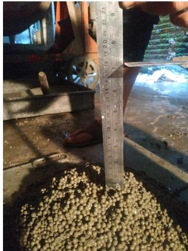
**Gambar 2.** Pengujian *Slump*
