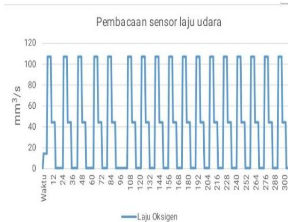
Gambar 5. Pengujian Ke-1 Laju Udara dengan Motor Stepper Nema 23
