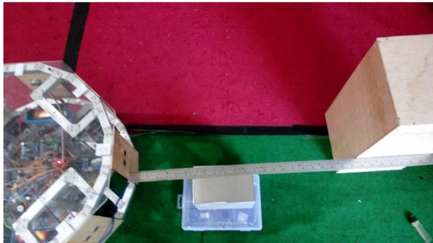
Gambar 2. Pengujian Sensor jarak SR-04
