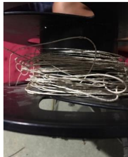
Gambar 3. Hasil filamen ABS pada percobaan pertama dan kedua
