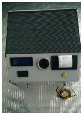
Gambar 1. Alat Uji Emisi Berbasis Arduino
