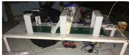
Gambar 2 Pembuatan konveyor Proses pembuatan konveyor menggunakan bahan besi dan motor *stepper* sebagai penggerak utamanya. Tiang menggunakan akrilik untuk meletakkan motor dc dan selang kecil.
