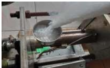
Gambar 3. Proses memasukan bahan plastik ke hopper
