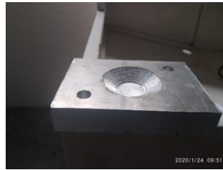
Gambar 4. Hasil proses CNC roughing cavity pada alumunium 6061
