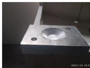
Gambar 4. Hasil proses CNC *roughing* cavity pada alumunium 6061
