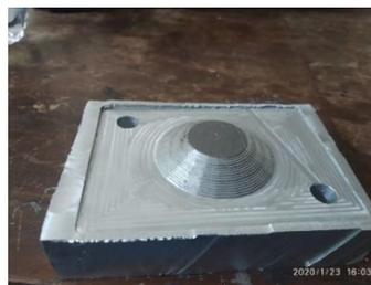
Gambar 6. Hasil proses CNC core dengan alumunium 6061
