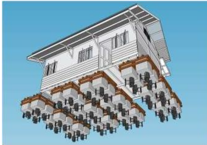
Gambar 7. Ilustrasi rumah apung dilihat dari bawah (Bila seluruh fondasi menggunakan Arka Tidal Energi Modulam)
