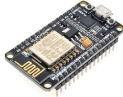
Gambar 3 Modul ESP8266
