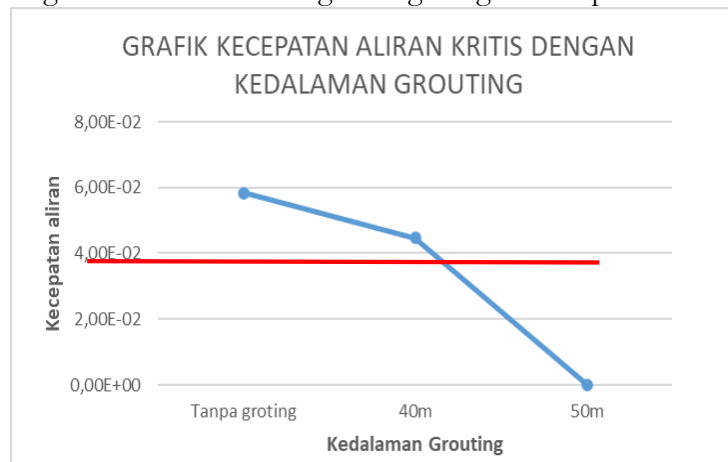
Gambar 20. Grafik hubungan kecepatan aliran kritis dengan kedalaman grouting
