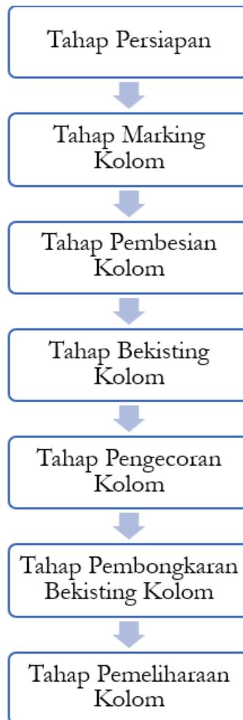
Gambar 1. Bagan Urutan Pekerjaan Struktur Kolom
