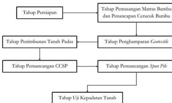
Gambar 1. Bagan Alur Pekerjaan Tanah dan Struktur Tanggul
