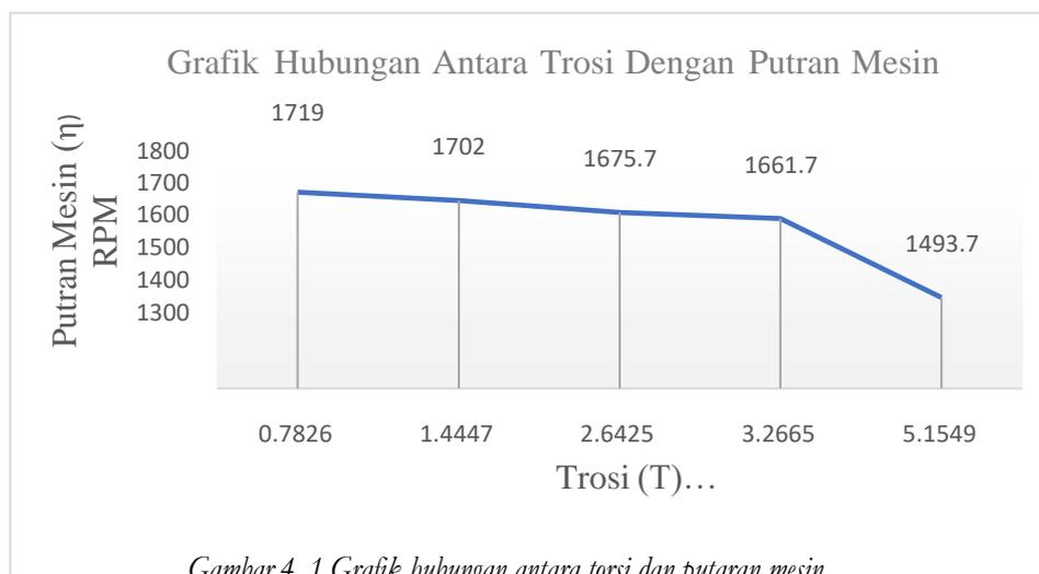
Gambar 4. 1 Grafik hubungan antara torsi dan putaran mesin
