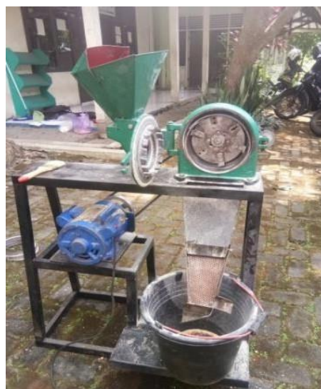
Gambar 2. Mesin Penggiling Biji Jagung
