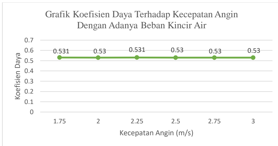
Gambar 8. Grafik Koefisien Daya Terhadap Kecepatan Angin Dengan Adanya Beban Kincir Air
