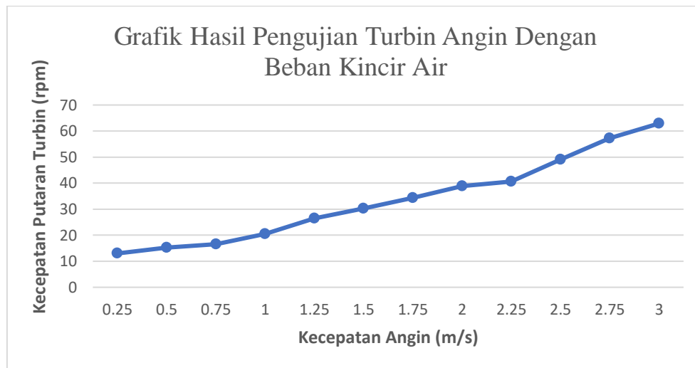
Gambar 7. Grafik Hasil Pengujian Turbin Angin Dengan Adanya Beban Kincir Air
