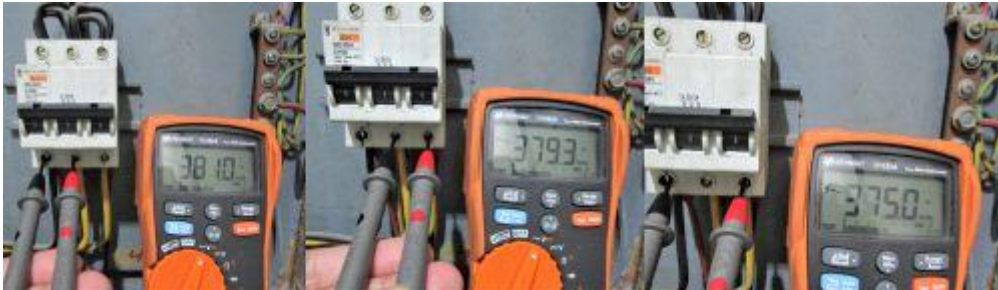
Gambar 5. Pengecekan input 3 fasa
