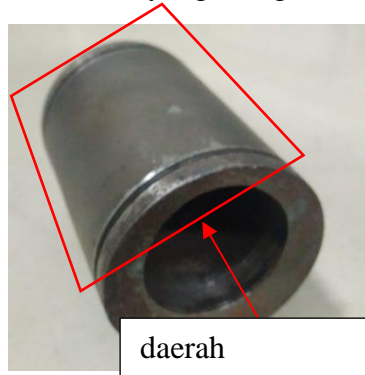
Gambar 12. Foto makro permukaan selimut poros eksentrik
