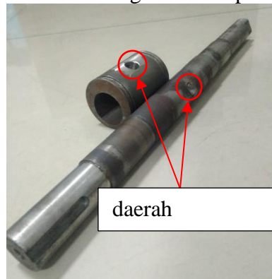
Gambar 14. Foto makro lubang pasak (pin) pada poros eksentrik dan poros as
