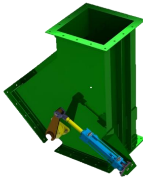
Gambar 7. Rancangan Diverter Gate untuk BC 07 (tampak samping dengan cover )
