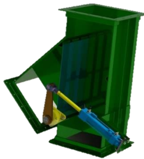
Gambar 8. Rancangan Diverter Gate untuk BC 07 (tampak samping tanpa cover )
