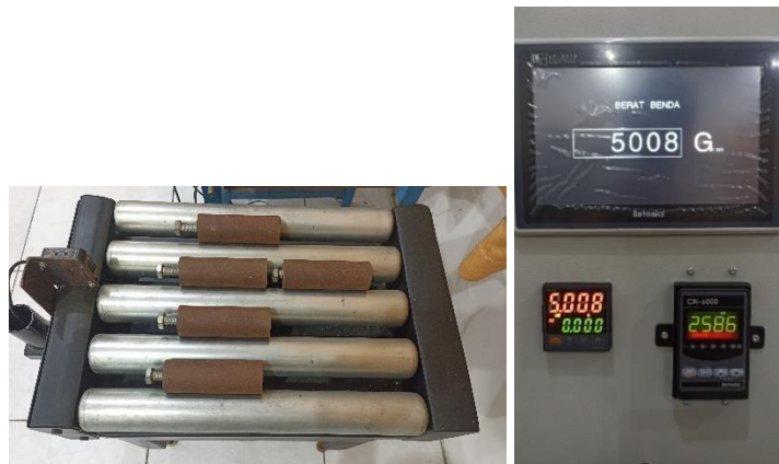
Gambar 6. Percobaan Pengukuran Beban 5 Kilogram
