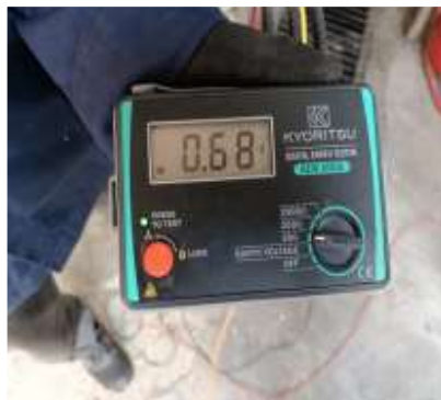
Gambar 6. Hasil pengukuran tahanan pembumian area mesin-generator
