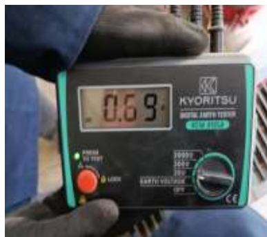
Gambar 2. Hasil pengukuran tahanan pembumian area ruang panel
