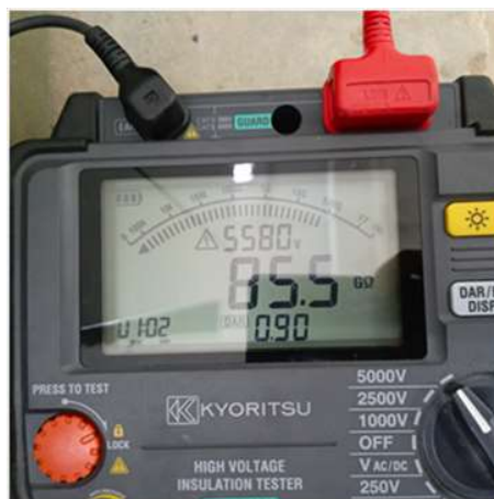
Gambar 3. Hasil Pengukuran Tahanan Isolasi Kabel Dari PHB TM Pelanggan ke Trafo
