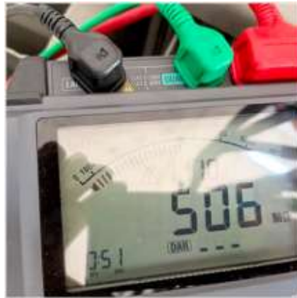
Gambar 2. Hasil pengukuran tahanan isolasi transformator
