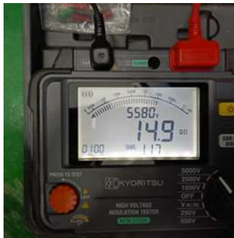
Gambar 5. Hasil Pengukuran Tahanan Isolasi Kabel Dari Cubicle PLN ke PHB TM Pelanggan
