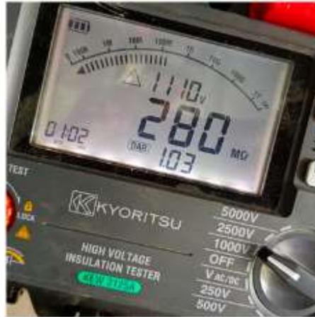
Gambar 6. Hasil Pengukuran Tahanan Isolasi Kabel Dari Trafo ke PHB TR
