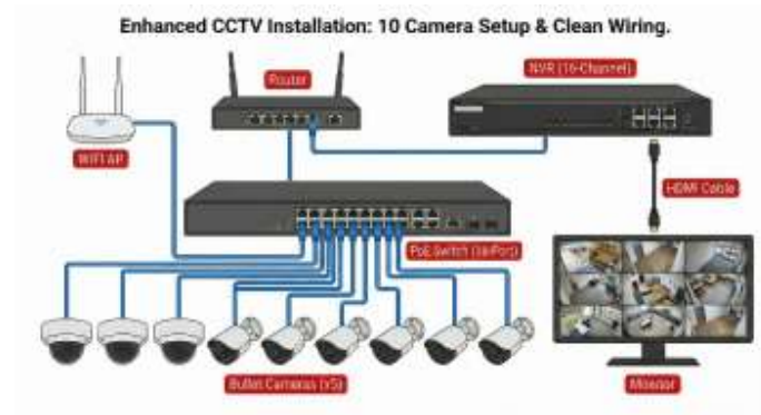
Gambar 1. Skema Topologi Jaringan CCTV Terintegrasi dengan PoE Switch dan NVR.
