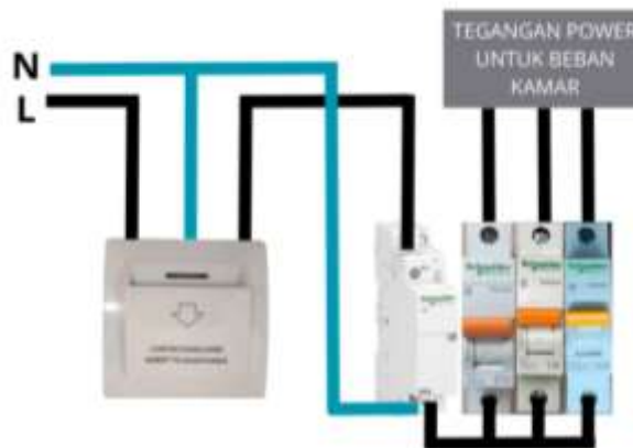
Gambar 3. Gambar Diagram Kontrol Efisiensi Energi Berbasis Kontaktor dan Key Card
