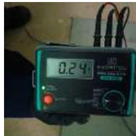
Gambar 5. Hasil Ukur Tahanan Pembumian Bangunan Gardu-Ground
