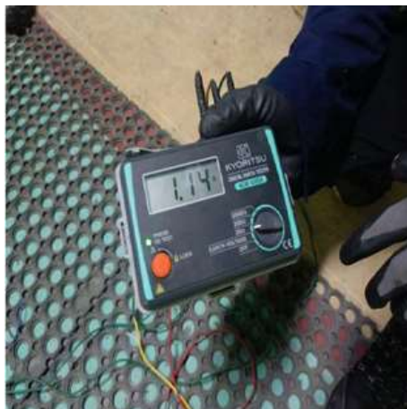
Gambar 5. Hasil Ukur Tahanan Pembumian Netral-Ground
