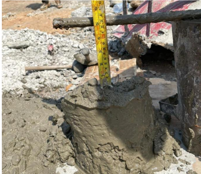
Gambar 12 Pengecekan Slump Test untuk Pengecoran Balok dan Pelat Lantai
