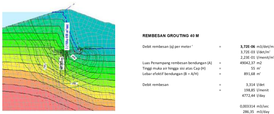
Gambar 12. Hasil running perhitungan rembesan dengan grouting 40 m Dari hasil running program Seep-W geostudio di dapatkan bahwa Debit rembesan melebihi 0,05 % tampungan efektif waduk , hal ini dapat mengakibatkan Piping dan besarnya debit rembesan yang terjadi
