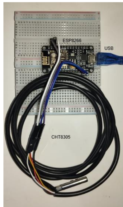
Gambar 5 Rangkaian elektronik sensor CHT8305
