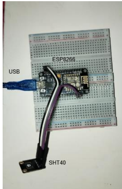
Gambar 4 Rangkaian elektronik sensor SHT40
