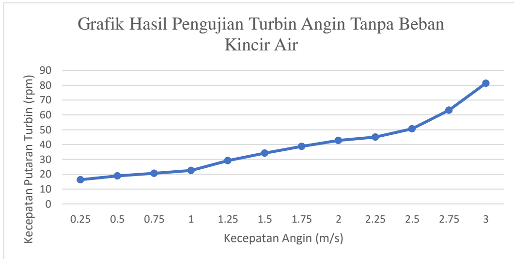
Gambar 3. Grafik Hasil Pengujian Turbin Angin Tanpa Beban Kincir Air
