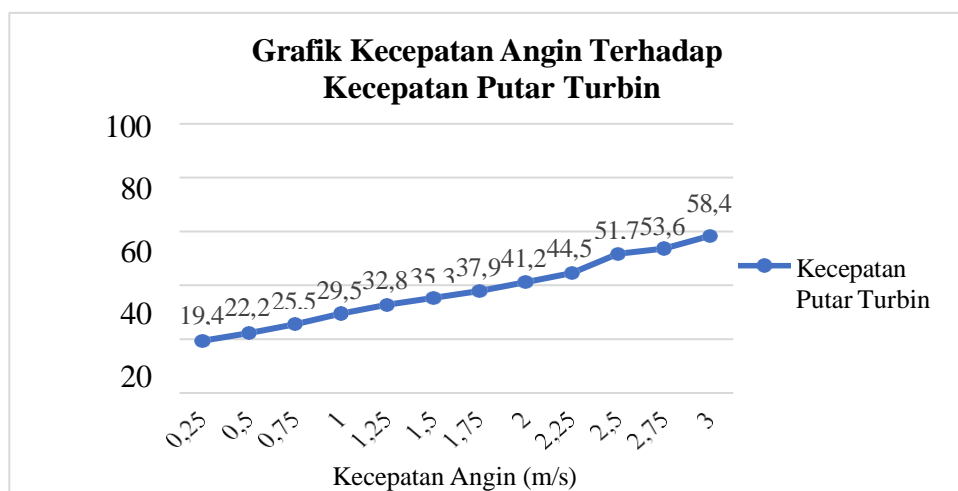
Gambar 3. Grafik Hasil Pengujian Turbin Angin Tanpa Beban Kincir Air
