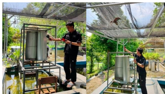
Gambar 2. Pengujian dan Pengambilan Data Turbin Angin Savonius 3 Blade
