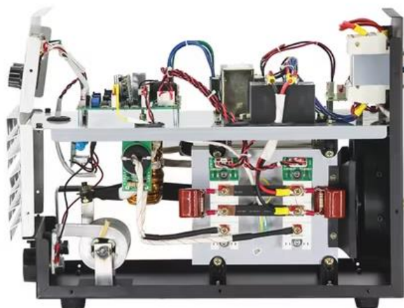
Gambar 1. Komponen Mesin Las MIG Inverter
