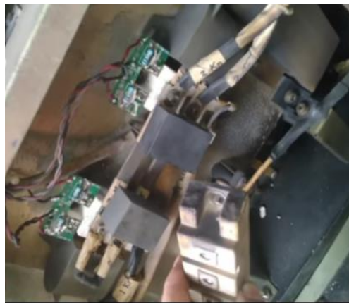
Gambar 6. Dioda modul rusak
