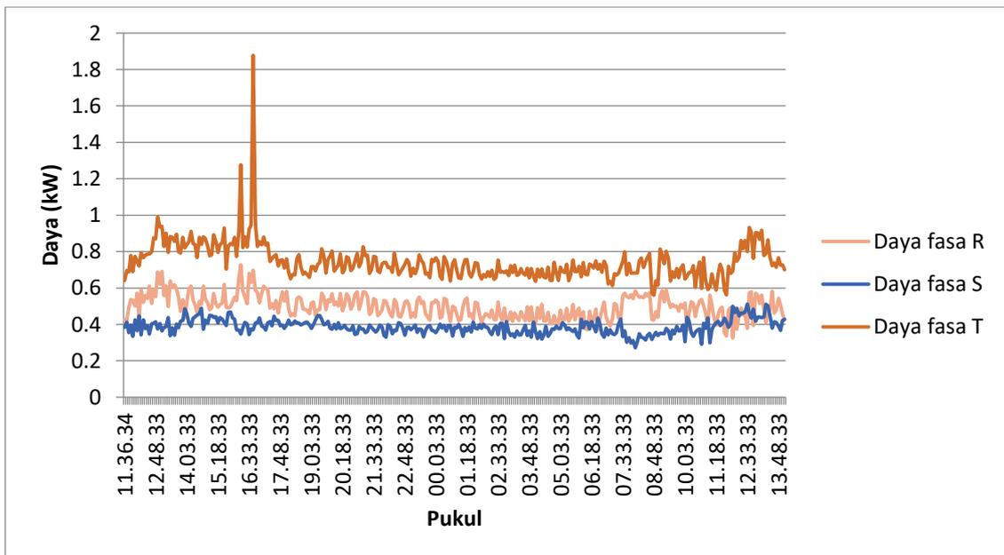
Gambar 1. Hasil pengukuran daya listrik ketiga fasa
