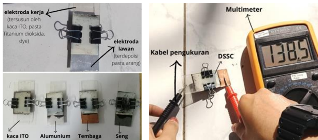
Gambar 1. DSSC pewarna kulit buah naga merah (kiri) dan pengujian elektrisitas DSSC (kanan)
