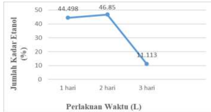
Gambar 2 Diagram Garis Perlakuan Waktu Fermentasi Terhadap Kadar Etanol Pada Produksi Bioetanol Limbah Durian ( Durio zhibetinus )
